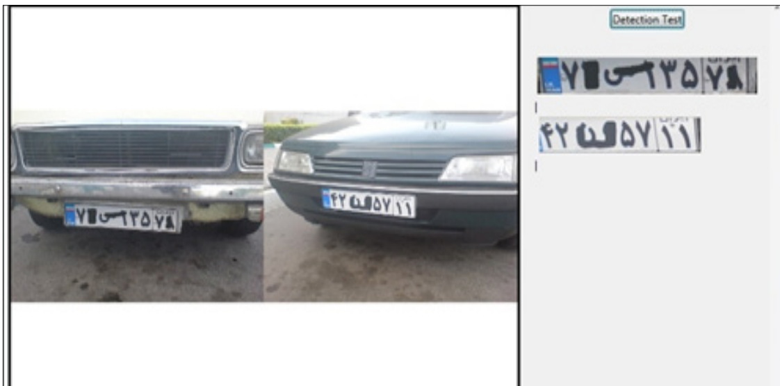
شکل (۱۴): نمونه‌ای از دو پلاک پیدا شده به همراه اصلاح چرخش در یک تصویر در اندازه‌ی اصلی که بطور مصنوعی مخدوش شده‌اند
