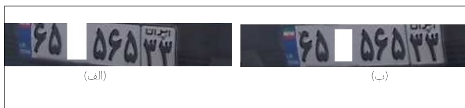
شکل (۱۰): (الف): استخراج و (ب): اصلاح چرخش یک ROI نمونه (به منظور رعایت حریم خصوصی قسمتی از پلاک مخفی شده است) افکشن عمودی برای تعیین محل پلاک خودرو
